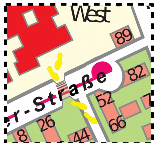
Überquerung mit Gehwegnasen und Markierungen
